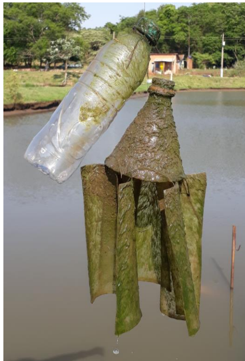
Figura 2: Lâminas confeccionadas de PET após 30 dias submersas no tanque da piscicultura.
